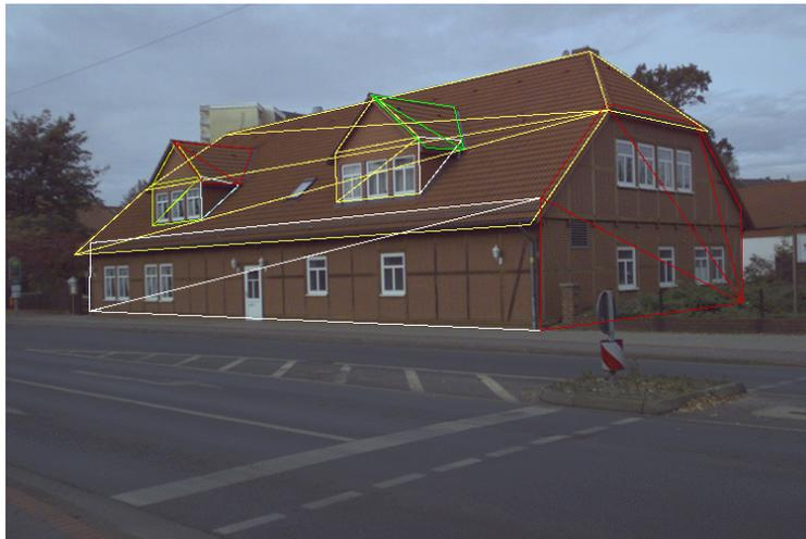
Abbildung 8.7.: Drahtnetzdarstellung nach erfolgter Registrierung
