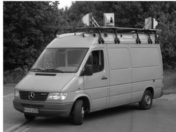
**Abb. 1:** Prototyp eines CityServer®-Aufnahmefahrzeuges mit 3D-Laser-Erweiterung
