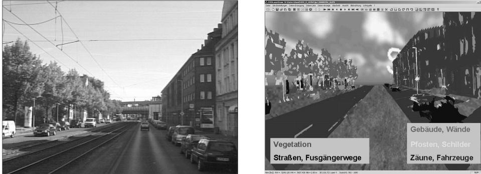
Abb. 8 u. 9: Straßenzug im Bild der Frontkamera und als 3D-Laserdatenmodell
