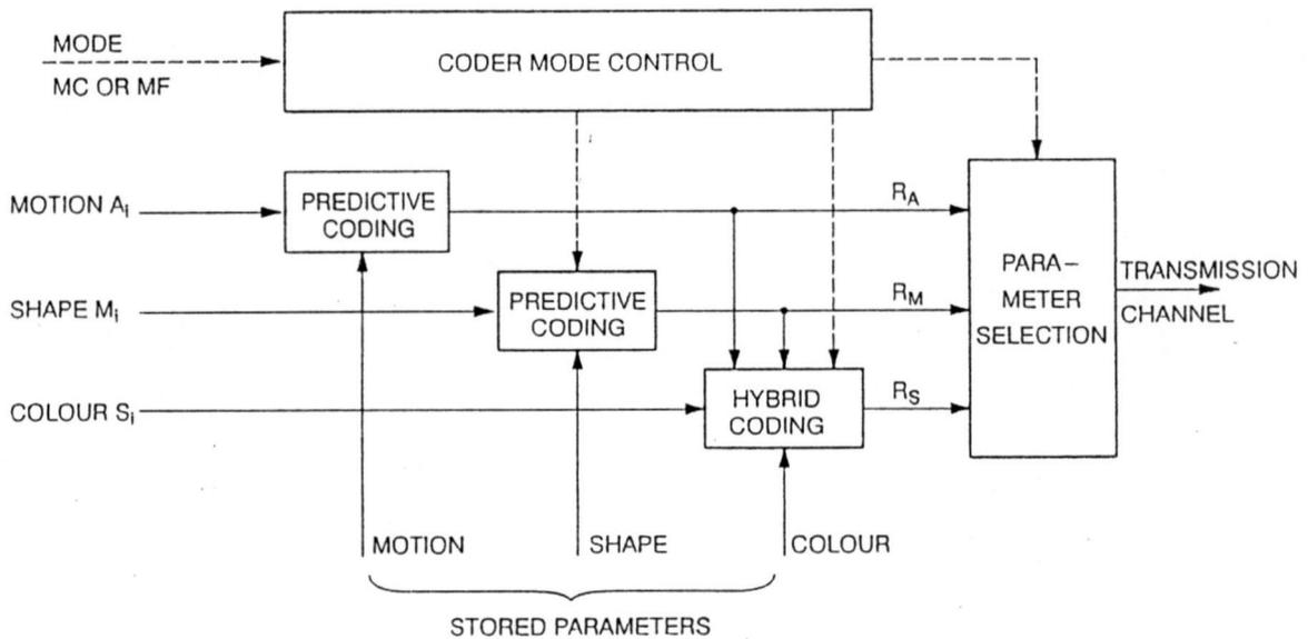
Fig. 2. Block diagram of the parameter coder
